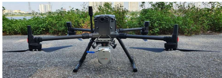
Hình 4: Lắp đặt AA450 trên DJI M300
