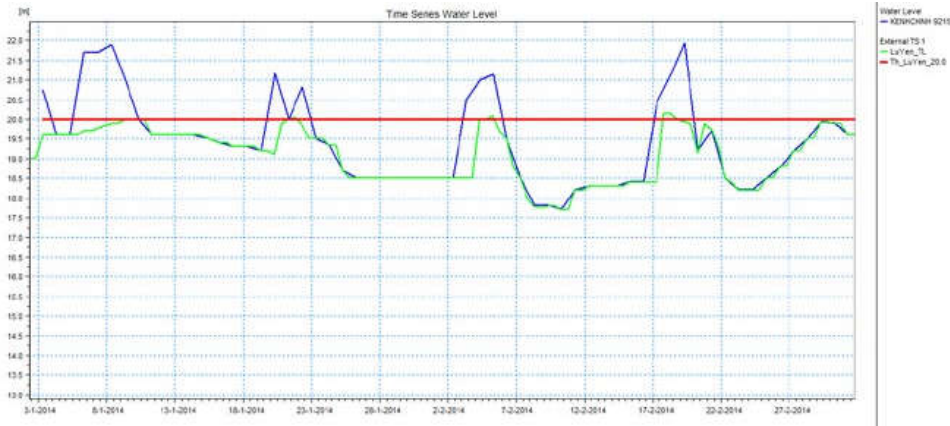
Hình 10: Biểu đồ đường quá trình mực nước thực đo (màu xanh lá cây) và tính toán (màu xanh nước biển) tại khu Thượng Lũ Yên GD1; đường màu đỏ là cốt nước yêu cầu
